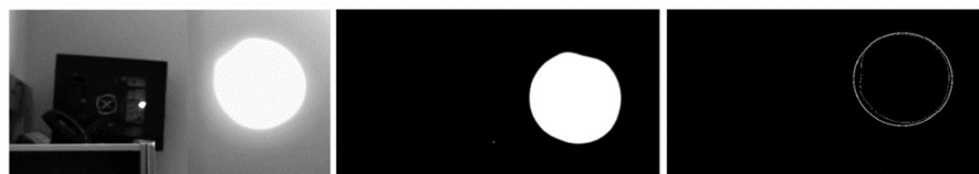
Рисунок 2. Изображение на каждом этапе алгоритма. (а) Исходное изображение, снятое с камеры. (б) Изображение после пороговой обработки и размытия. (с) Окружность, подогнанная под обнаруженные контуры.
