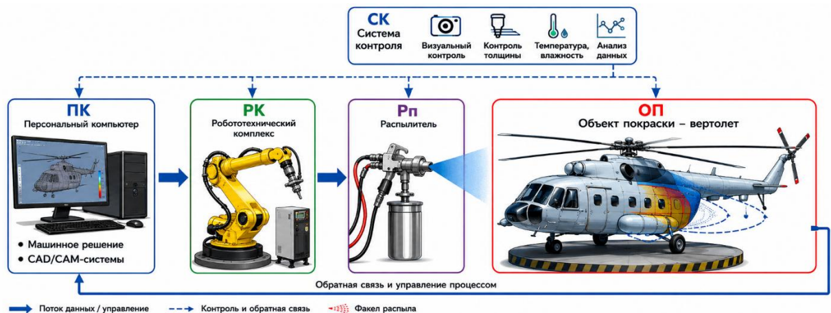
Рисунок 2 – Структурная схема роботизированной системы управления нанесением лакокрасочных и антикоррозионных покрытий
