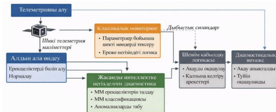
Сурет 3 – Классикалық телеметриялық бақылау мен ЖИ негізіндегі ақауларды анықтауды біріктіретін гибриді борттық диагностикалық жүйе архитектурасы
