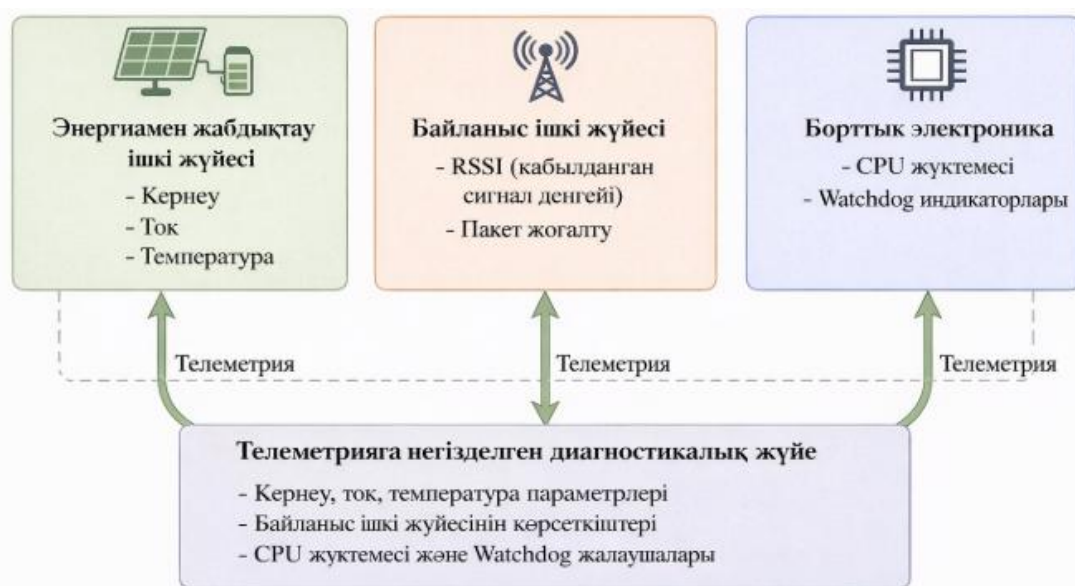
Сурет 1 – Наноспутник ішкіжүйелерінің телеметрияға негізделген бейнеленуі және деректердің борттық диагностикалық жүйеге ағу сызбасы
