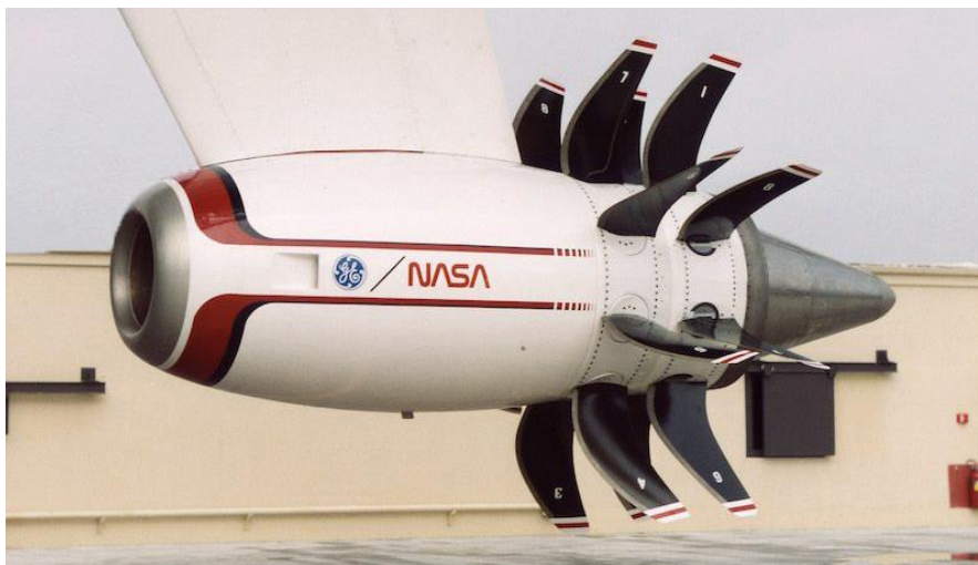
Рисунок 2. Экспериментальный авиадвигатель GE36 во время наземных испытаний
