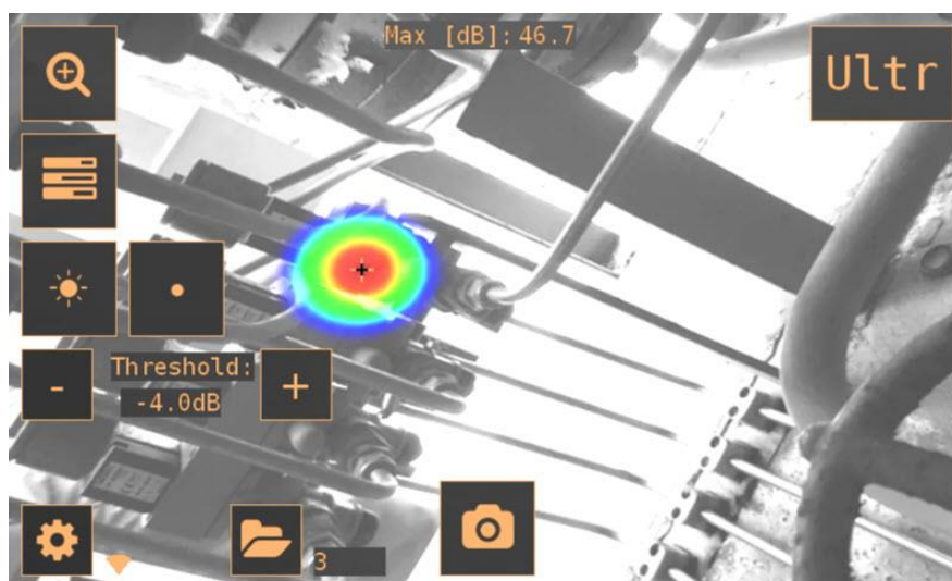
Рисунок 3 – Локализация источника звука в цветном режиме в виде тепловой карты в зависимости от интенсивности [28]
