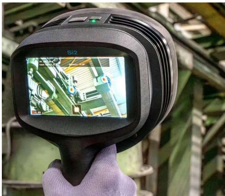
Рисунок 2 – Выявление скрытых источников воздуха и утечек газа прибором FLIR Si2 с возможностью визуализации источника [27]
