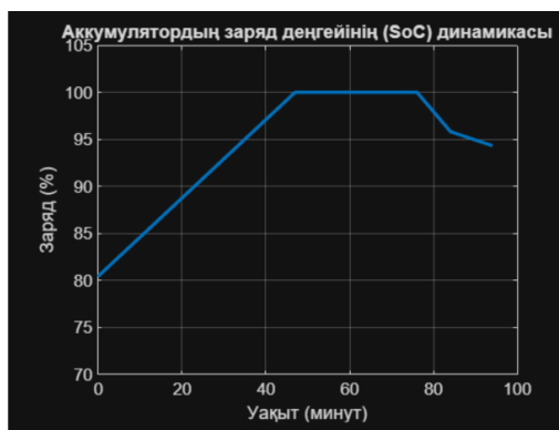
Сурет 3 – Оңтайландырылған жұмыс режиміндегі аккумулятордың заряд деңгейінің (SoC) динамикасы
