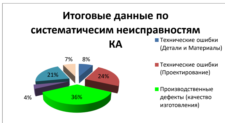
Рисунок 3. Систематические неисправности космических аппаратов (из источника [7])
