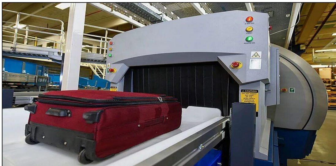
Рисунок 4. Процесс досмотра багажа томографом в аэропорту «Платов»
