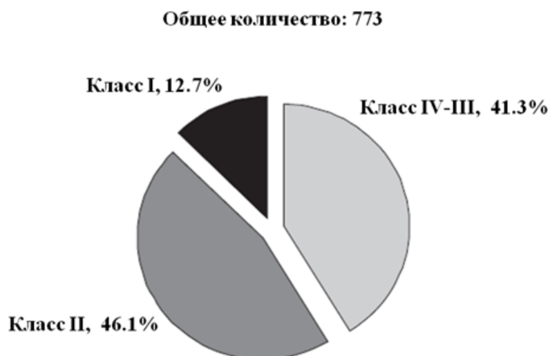
Рисунок 1. Распределение неисправностей и отказов по степени тяжести для космических аппаратов, успешно запущенных в период с января 1990 г. по октябрь 2008 г [21]
