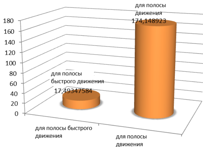
Рисунок 3. Время, затрачиваемое легкими самолетами с момента их касания взлетно-посадочной полосы до момента их покидания (секунд).
