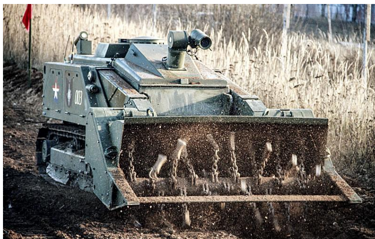
Рисунок 2 – Пример механического разминирования роботизированным комплексом «Уран-6»
